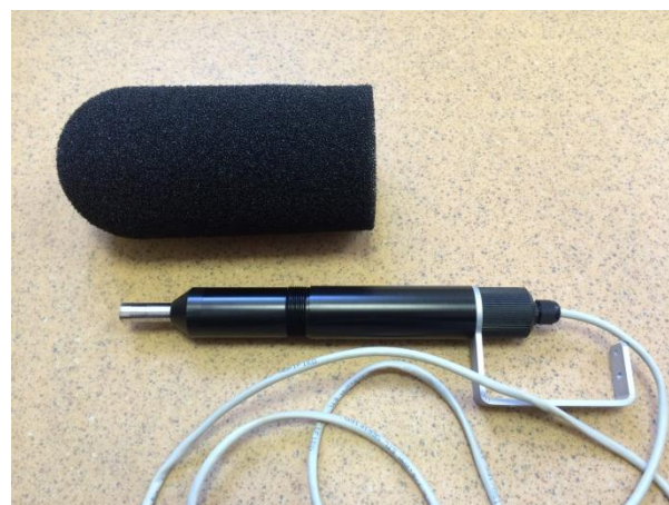
Рис.1е. Заключительный этап сборки: оденьте ветрозащиту на микрофон
