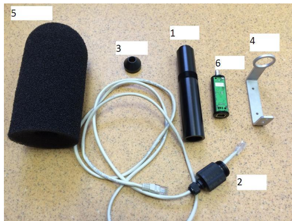
Рис.1б. Составные части EPS-ETH-04 (1-4, 6) и ветрозащита WS009-F (5)
