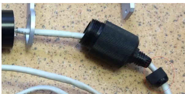
Рис.1д. Устройство с открученным гермовводом
