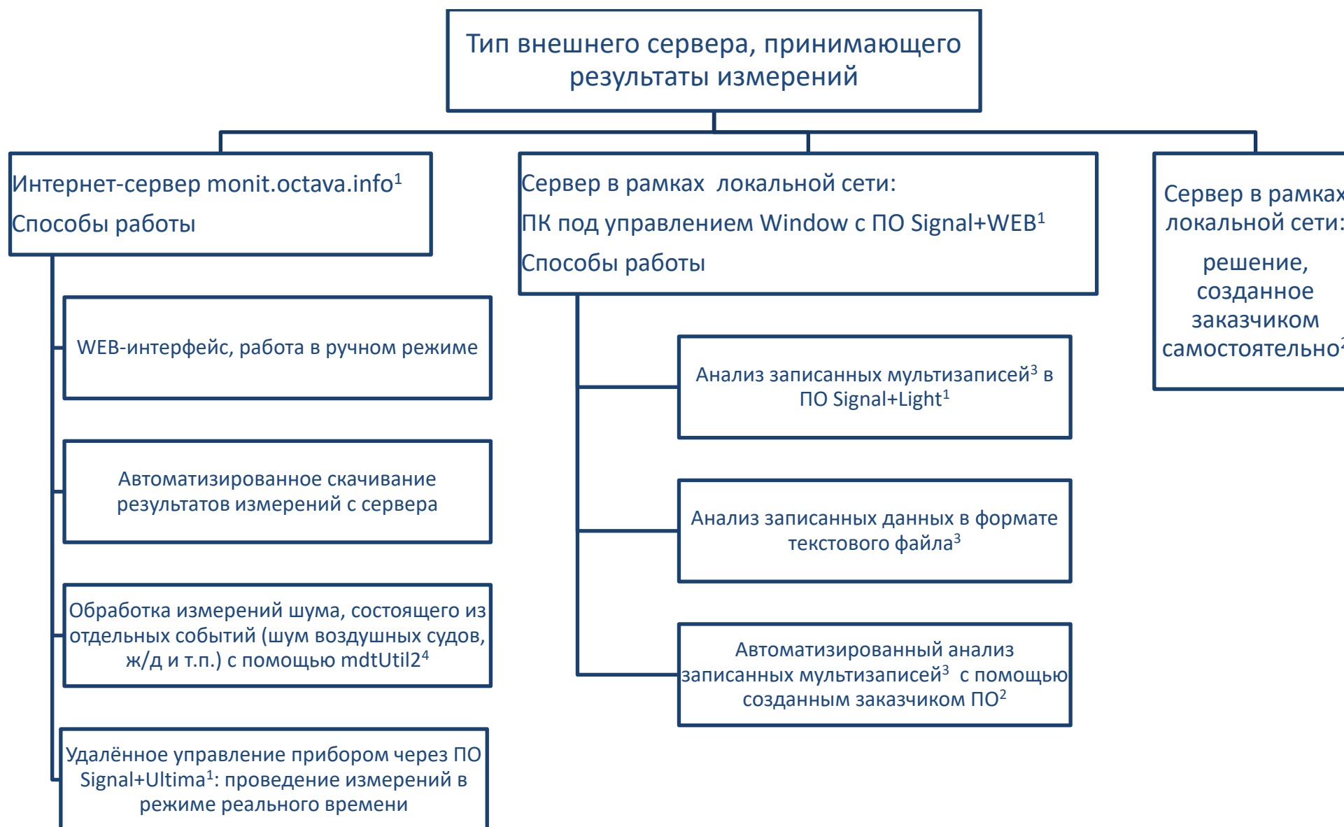
Рис. 3. Способы подключения Октафон-110А.ІР и работы с полученными данными
