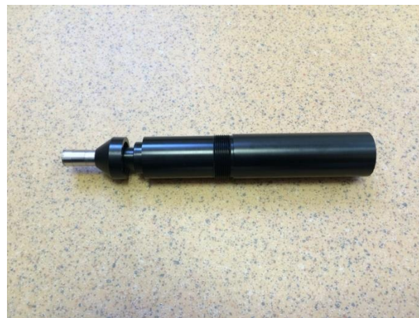
Рис.1г. Заключительный этап установки гермоколпачка: задвиньте гермоколпачок на корпус
